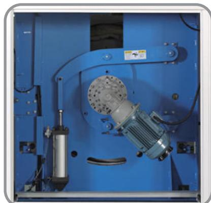
• Sistema di trasmissione con motoriduttore, per garantire una elevata potenza, resistenza e silenziosità.
